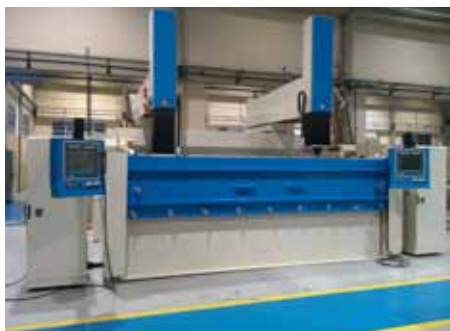
Novinkou prezentovanou v brazilském Joinville byla obří hloubička PENTA 3010-2H se dvěma erodovacími hlavami
