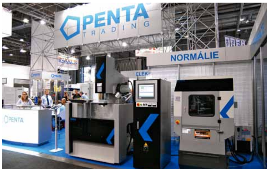
Hloubička PENTA 433G CNC v kombinaci s vertikálním frézovacím centrem P 432 HSC pro obrábění elektrod
